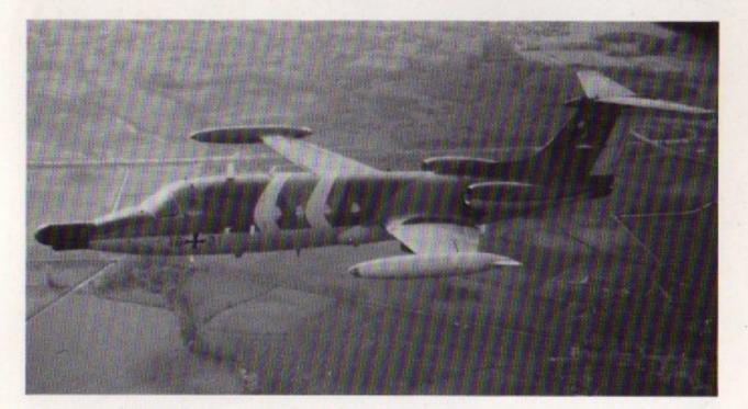
Flugzeug für EloKa-Ausbildung: Spannweite 14,50 m, Höhe 5,00 m, Länge 17,50 m, max. Schub 2 x 1410 kp, Höchstgeschwindigkeit Mach 0,74. Fliegende Besatzung: 2. Taktische Besatzung: 3. Bei TAM geflogen von: Bundesrepublik Deutschland.
