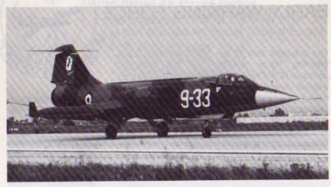
Einsitziges Mehrzweckkampfflugzeug: Spannweite 6,68 m, Höhe 4,11 m, Länge 16,69 m, max. Schub 1 x 8120 kp, Höchstgeschwindigkeit Mach 2,2. Bei TAM geflogen von: Italien.
