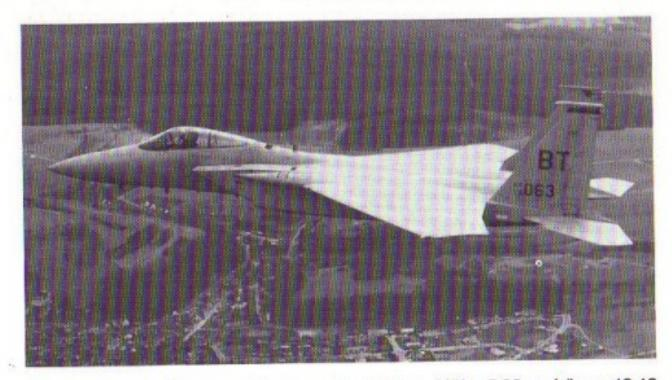
Einsitziges Jagdflugzeug: Spannweite 13,05 m, Höhe 5,63 m, Länge 19,43 m, max. Schub 2 x 10810 kp, Höchstgeschwindigkeit Mach 2,5. Bei TAM geflogen von: USA.
