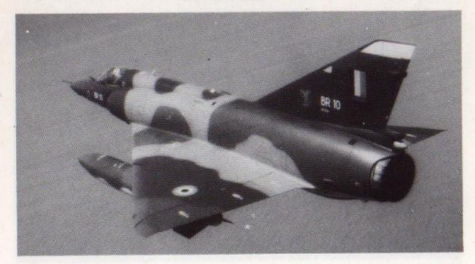
Einsitziger Jagdbomber: Spannweite 8,22 m, Höhe 4,50 m, Länge 15,55 m, max. Schub 1 x 6200 kp, Höchstgeschwindigkeit Mach 2,2. Bei TAM geflogen von: Belgien.
