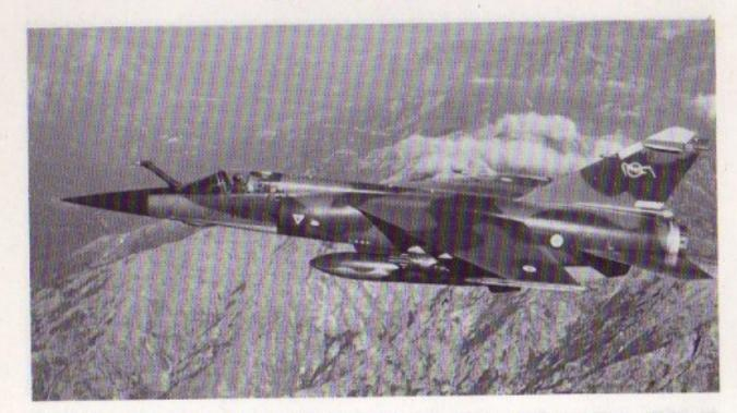
Einsitziges Mehrzweckkampfflugzeug: Spannweite 8,40 m, Höhe 4,50 m, Länge 15,30 m, max. Schub 1 x 7200 kp, Höchstgeschwindigkeit Mach 2,2. Bei TAM geflogen von: Frankreich.
