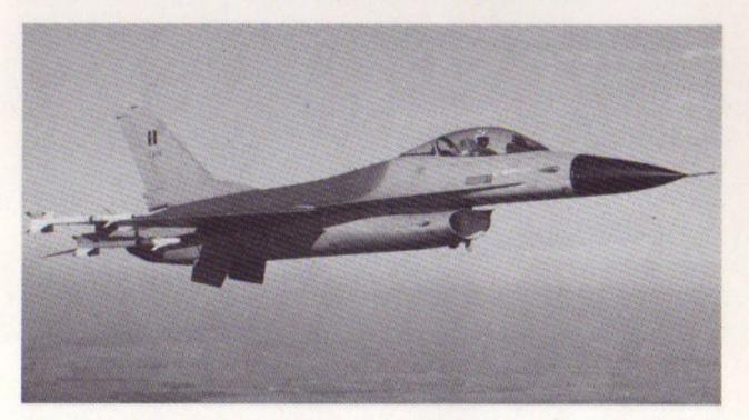
Einsitziges Jagdflugzeug: Spannweite 9,45 m, Höhe 5,09 m, Länge 15,03 m, max. Schub 1 x 13155 kp, Höchstgeschwindigkeit Mach 2,0. Bei TAM geflogen von: Belgien, Dänemark, USA.
