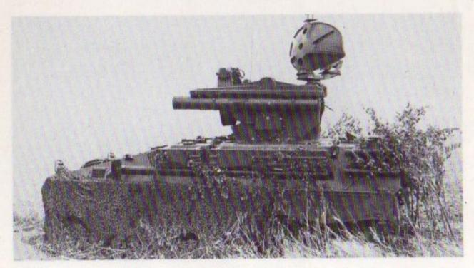
Mobiles Flugabwehrraketensystem (Boden/Luft-Lenkflugkörper) für niedrige und sehr niedrige Höhen. Länge des Flugkörpers 2,40 m, Durchmesser 16 cm, Spannweite 50 cm, Reichweite 8 km, Geschwindigkeit Mach 1,5. Bei TAM eingesetzt von: Frankreich.
