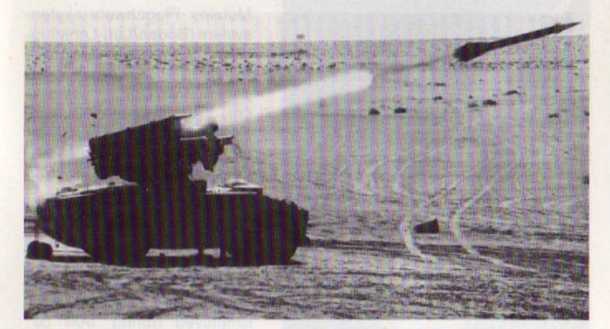
Mobiles Flugabwehrraketensystem (Boden/Luft-Lenkflugkörper) für niedrige und sehr niedrige Höhen. Länge des Flugkörpers 2,94 m, Durchmesser 16 cm, Spannweite 54 cm, Reichweite 8 km, Geschwindigkeit Mach 2,3. Bei TAM eingesetzt von: Frankreich.
