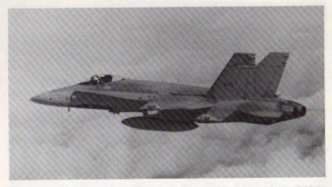
Einsitziges Jagdflugzeug: Spannweite 12,44 m, Höhe 4,69 m, Länge 17,33 m, max. Schub 2 x 7270 kp, Höchstgeschwindigkeit Mach 1,8. Bei TAM geflogen von: Kanada.
