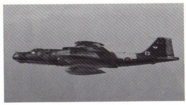
Flugzeug für EloKa-Ausbildung: Spannweite 19,97 m, Höhe 4,75 m, Länge 20,53 m, max. Schub 2 x 6123 kp, Höchstgeschwindigkeit 660 km/h. Besatzung: 3. Bei TAM geflogen von: Großbritannien
