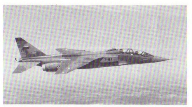
Einsitziges Mehrzweckkampfflugzeug: Spannweite 8,69 m, Höhe 4,89 m, Länge 16,83 m, max. Schub 2 x 3647 kp, Höchstgeschwindigkeit Mach 1,6. Bei TAM geflogen von: Frankreich, Großbritannien.
