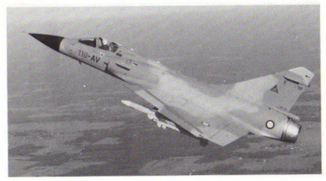
Einsitziges Jagdflugzeug: Spannweite 9,13 m, Höhe 5,20 m, Länge 14,36 m, max. Schub 1 x 9700 kp, Höchstgeschwindigkeit Mach 2,2. Bei TAM geflogen von: Frankreich.
